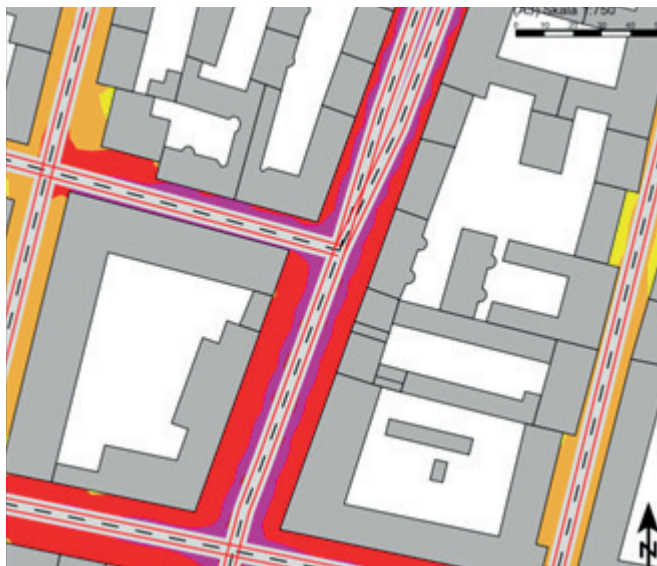
Figur 5. Beräkning av ljudnivå från vägtrafik omkring korsningen Sankt Eriksgatan och Alströmergatan, Stockholm. Bilar med förbränningsmotor respektive med elmotor. 10 % tung trafik, 50 km/h.
